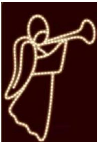
**A/A 37. (FS-LED No 2045 LED)** Φωτεινό σώμα **(ΕΠΙΣΤΗΛΙΟ ΔΙΑΚΟΣΜΗΤΙΚΟ)** αποτελούμενο από σκελετό αλουμινίου στερεά συγκολλημένου με καλαίσθητες ενώσεις πάνω στον οποίο δένεται μονοκάναλος εύκαμπτος φωτοσωλήνας LED με 36 LED ανά μέτρο, διαμέτρου 13mm. Η κατανομή φωτός θα είναι ισομερής με καθαρότητα και φωτεινότητα. Η τάση λειτουργίας θα είναι 220-240V, με 100.000 ωρών συνεχούς λειτουργίας και δείκτη στεγανότητας IP65 προκειμένου για χρήση σε εξωτερικό χώρο.
