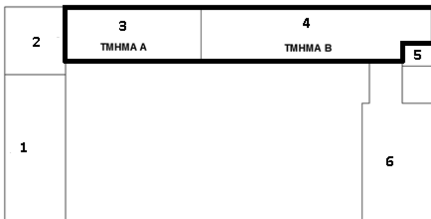
Σχήμα 1: Διαχωρισμός του κτηρίου σε έξι στατικά ανεξάρτητα τμήματα
