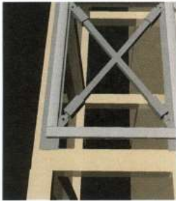
BRUP χρησιμοποιούνται σαν αποσβεστήρες, αντικαθιστώντας τις διαγώνιες ράβδους των ανώτερων ορόφων.
