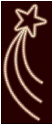
**A/A 36. (FS-LED No 2043 LED)** Φωτεινό σώμα **(ΕΠΙΣΤΗΛΙΟ ΔΙΑΚΟΣΜΗΤΙΚΟ)** αποτελούμενο από σκελετό αλουμινίου στερεά συγκολλημένου με καλαίσθητες ενώσεις πάνω στον οποίο δένεται μονοκάναλος εύκαμπτος φωτοσωλήνας LED με 36 LED ανά μέτρο, διαμέτρου 13mm. Η κατανομή φωτός θα είναι ισομερής με καθαρότητα και φωτεινότητα. Η τάση λειτουργίας θα είναι 220-240V, με 100.000 ωρών συνεχούς λειτουργίας και δείκτη στεγανότητας IP65 προκειμένου για χρήση σε εξωτερικό χώρο.
