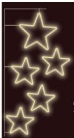
**A/A 33. (FS-LED No 1013 LED)** Φωτεινό σώμα (**ΕΠΙΣΤΗΛΙΟ ΔΙΑΚΟΣΜΗΤΙΚΟ**) αποτελούμενο από σκελετό αλουμινίου στερεά συγκολλημένου με καλαίσθητες ενώσεις πάνω στον οποίο δένεται μονοκάναλος εύκαμπτος φωτοσωλήνας LED με 36 LED ανά μέτρο, διαμέτρου 13mm. Η κατανομή φωτός θα είναι ισομερής με καθαρότητα και φωτεινότητα. Η τάση λειτουργίας θα είναι 220-240V, με 100.000 ωρών συνεχούς λειτουργίας και δείκτη στεγανότητας IP65 προκειμένου για χρήση σε εξωτερικό χώρο.
